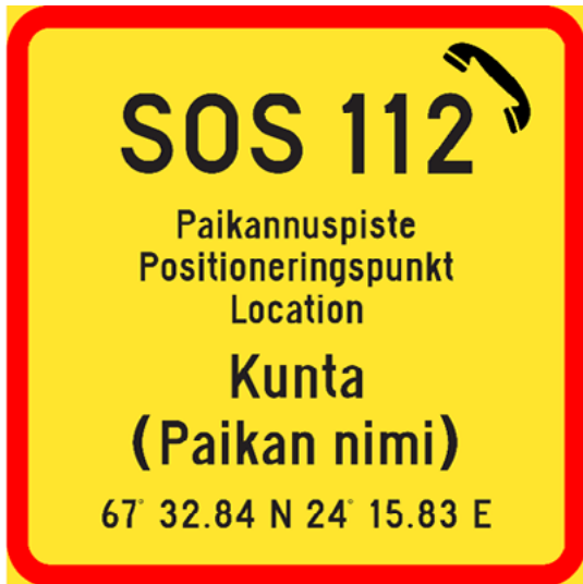
Kuva 31. Tielikennelain mukainen paikannuspistemerkki, jota käytetään tieliikennelain alaisilla reiteillä. Merkki on keltainen ja siinä on punainen reunaviiva.
