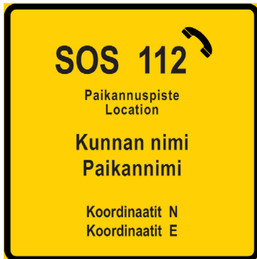
Kuva 32. Muilla kuin tieliikennelain alaisilla reiteillä käytettävä paikannuspistemerkki. Merkki on keltainen ja siinä on musta reunaviiva.
