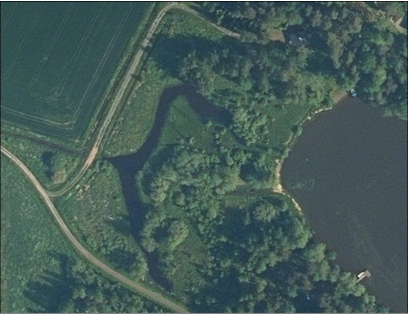
Kampakosteikko. Valtaoja laskee kanavamaiseen altaaseen, josta vesi suodattuu luontaisen kosteikon läpi vesistöön. (ilmakuva: MML 10/2019)
